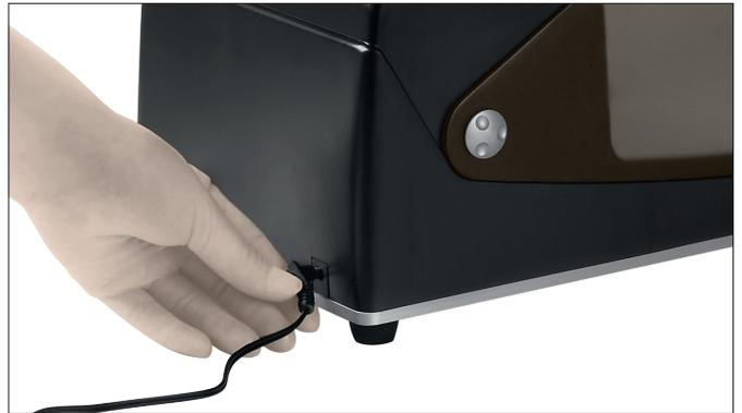
Den Druckluftschlauch in den Luftanschluss an der Rückseite des Geräts stecken, anschließend den Druckluftnippel des pneumatischen Anschlusses an die Luftversorgung anschließen. Den Luftdruck der Luftversorgung auf 5–10 bar einstellen.
